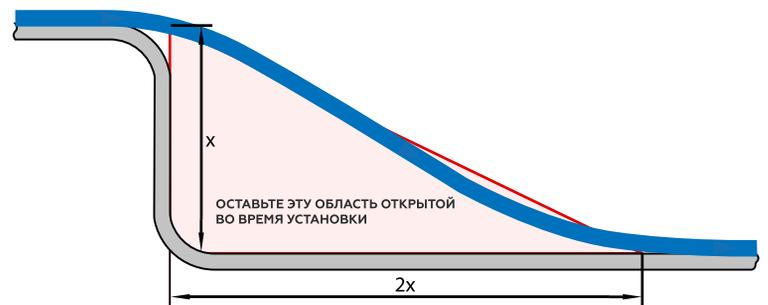
Перепад высот, при котором зазор между проходами составляет двойное расстояние между шагами, не ограничивают длину РИЗУРПАК. Прокладку, которая не соответствует рекомендациям, следует планировать как несколько трасс, соединенных перемычками.
