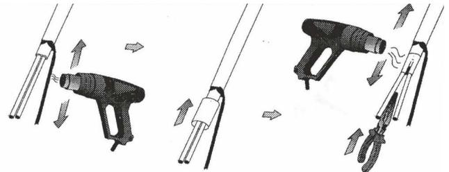
Осадите термоусадочную трубку на жиле техническим феном, на греющий кабель наденьте термоусадку, техническим феном осадите термоусадку и пассатижами сожмите нагретую термоусадку.
