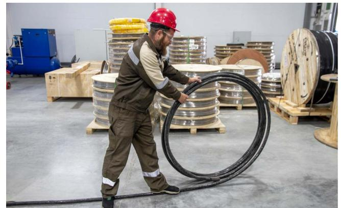
Метод 2. Используйте вторую катушку меньшего размера, чтобы выпрямить РИЗУРПАК®, когда пучок трубок снимается с транспортировочной катушки.
