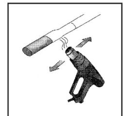
На «ступеньку» надеть резиновый концевик и на кабель термоусадку. Осадить термоусадку техническим феном
