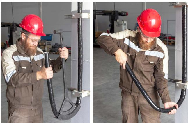
Метод 2. Крепко возьмите пучок и поверните его на 90°, затем сделайте изгиб. Этот метод также можно использовать для позиционирования трубы для технологического соединения.
