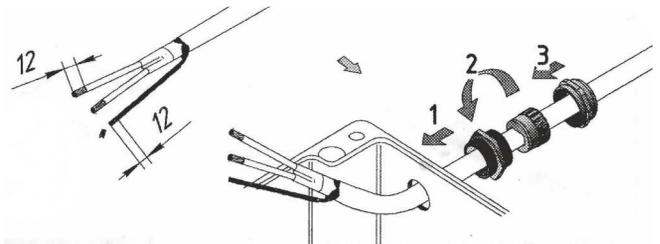
Подготовьте жилы и оплетку для соединения, пропустите разделанный конец греющего кабеля через отверстия и установите кабельный ввод.
