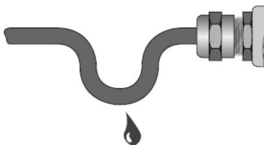
Рисунок 6 - Присоединение кабеля к прибору
