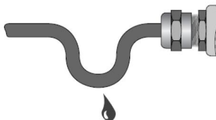
Рисунок 8 - Присоединение кабеля к прибору
